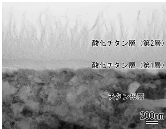
図6 熱処理されたインプラント表面の断面 TEM 像
