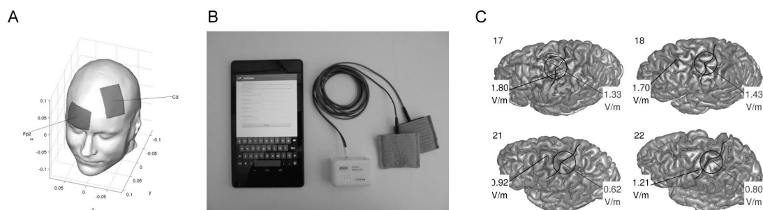
図 1(A)経頭蓋直流電気刺激法(tDCS)。電極を刺激したい脳領域の直上に貼り付け、1mA 程度の微弱な直流電流を通電し皮質興奮性を高める。(B)我々が開発したウェアラブル直流刺激装置。従来の物より小型であり、簡便かつ安価に tDCS が実現可能。(C)計算物理モデル実験による電流密度分布の個人差。個人により最大電流の観測場所が異なる。
