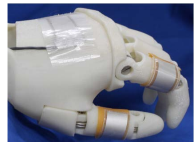
図11 振動伝播遮断構造とそれを実装した触覚センサ付装飾義手
