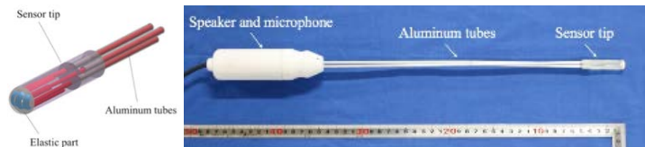
図5 押し込み型触覚センサ（3点の力から硬さを計測）
