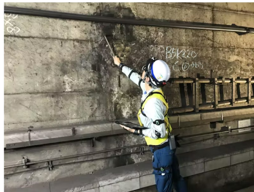
図 2：点検者にセンサーを取り付けたデータ取得実験の様子
