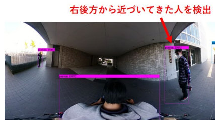
図6 全天球カメラによる人検出と車椅子搭乗者への音による注意支援
