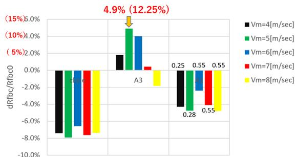
図 6.  $400\text{ m}$  水槽曳航試験による正味抵抗低減結果 (実験 A3, 速報値)
