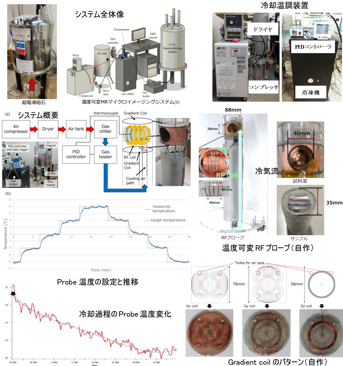
図7. 筑波大で作成した温度可変MRI装置システム概要と温調可能Probe(自作)とProbe温度の変化
