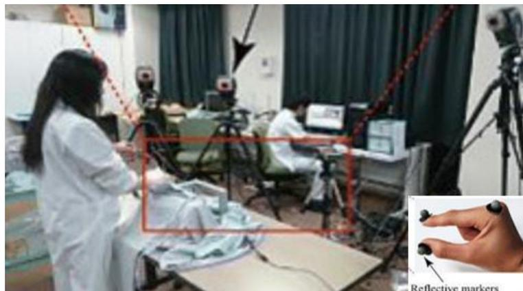
図 4 光学式モーションキャプチャによる吸引カテーテル操作（手指運動）の解析
