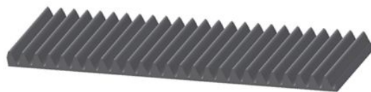
図2 グレーティングスケール(粗さ試料)。表面の波長の長さ(1.0-3.0 mm)によって特徴づけられる。
