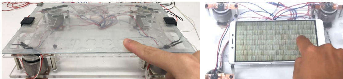
図1 本プロジェクトで開発した触感テクスチャディスプレイ。機械的振動刺激と静電摩擦刺激を併用した世界初の触感ディスプレイ。右は、スマートフォンに表示された画像(畳)の触感を提示している様子。
