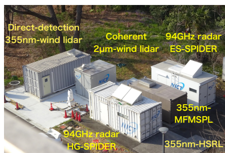
図1 (a) 次世代型アクティブセンサ複合観測システムの全体像と多視野角・多重散乱偏光ライダー
