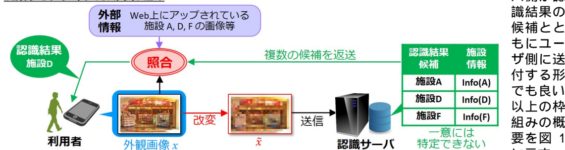
図 1 サーバ側による認識結果の特定が困難なメディア認識の枠組み
