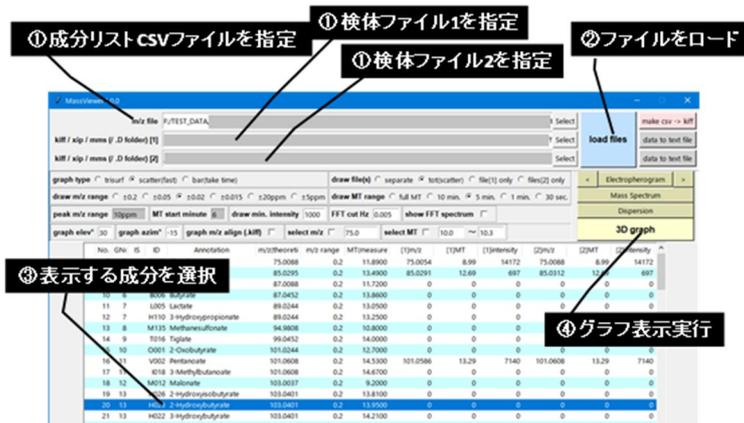
図2 データの可視化ツール MassView の GUI (操作画面) の部分で読み込む測定生データや、どの位置 ( $m/z$  と移動時間) のピークを可視化するかなどを指定し、にてデータのロード、にて成分表示、で各種グラフの表示を実行する。
