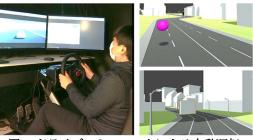
図1 ドライブシミュレータによる自動運転 (左)及び走行画面(右:障害物)の例.
