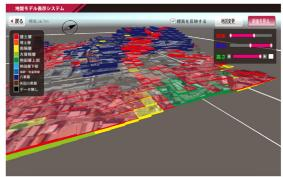
図8 3D表示ソフトウェア上に展開された表層地盤構造モデル 図9 表層地盤構造モデルに航空写真を重ね、標高に応じて地形を表現した例
