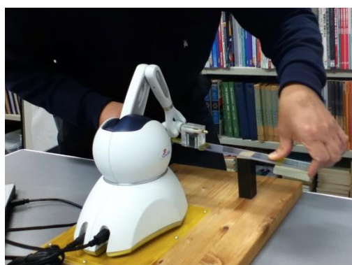
図 2. 平面仕上げ技能習得支援システム計測部の外観
