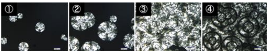
図10. 所定の時間-温度プロセス（図9）にしたがって可視化した構造逆転現象 [2].
