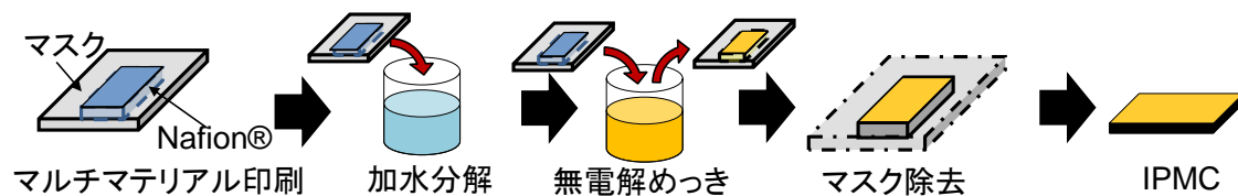
図 10 マルチマテリアル技術による絶縁工程を不要とする IPMC 作製工程
