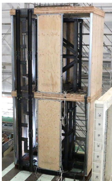
写真1 実大2層試験体
