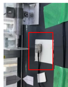
図3 Gyroセンサーの仕様 5) と設置状況(Gyroセンサー④)
