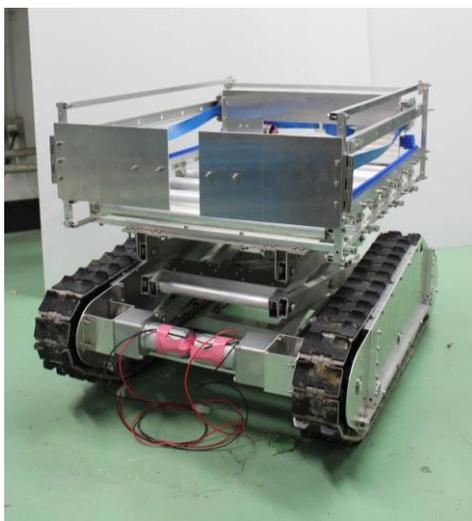
図 4 クローラ型ロボット
