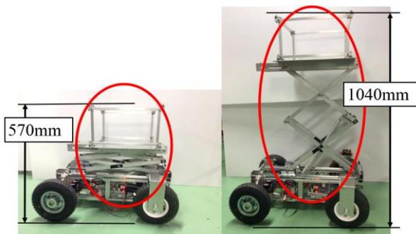
図 2 車輪型ロボットのカゴ持上げの様子
