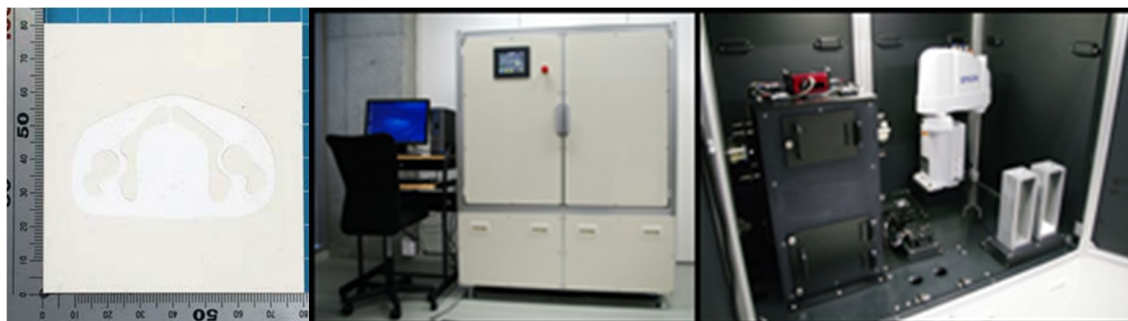
図4．密度制御熱蛍光板による骨盤部の人体模型線量計（左）と読取装置（中、右）
