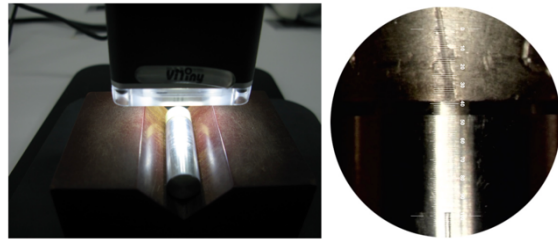
図3 FC型金型とフルクラウンの適合性評価
