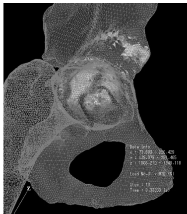
図2 CT画像から 骨盤と大腿骨を 三次元モデル化 有限要素解析で 関節面にかかる 応力を評価
