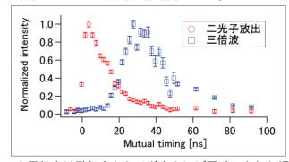
の時間差に対する依存性を右図に示す。二光子放出は励起光とトリガ光をほぼ同時に入れた場合に強度が最大になるが、三倍波は励起光からトリガ光を 40 ns 程度遅れて入射した場合に信
