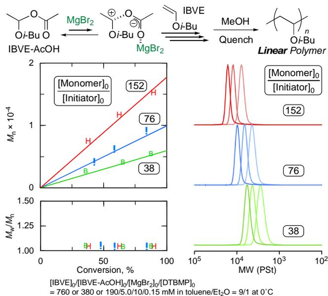
また、 $\text{MgBr}_2$  は環拡大カチオン重合のルイス酸触媒としても有効であった。特に、従来用いられてきた  $\text{SnBr}_4$  に比べて、開始剤種の適用範囲が広く、様々な環状開始剤を用いて、環拡大重合の制御が可能になり、オリンピックゲル構築の基盤系を構築できた。また、 $\text{MgBr}_2$  はジエチルエーテルに比較的良好に溶解することがわかり、
