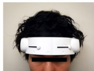
図1. 超小型近赤外分光装置
