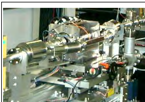
図5：ATF2 ビームラインに設置した永久磁石による最終集束レンズ
