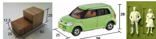
①ブロック模型 ②ミニカー模型 ③人体模型 図 9 風洞実験に用いた模型[単位: mm]
