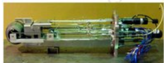
図-8 CPD装置の回転ドラム型リミター。
