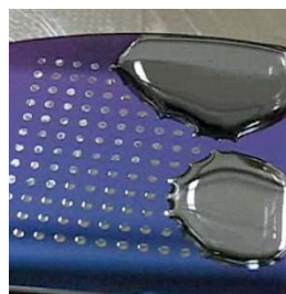
図1 パタンニングされた自己組織化単分子膜上に作製された有機半導体膜。
