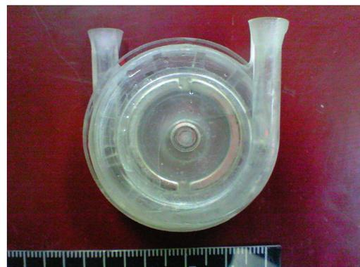
図 完成した螺旋流ポンプ
