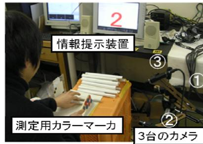
図2 映像・音声情報提示システムの構成
