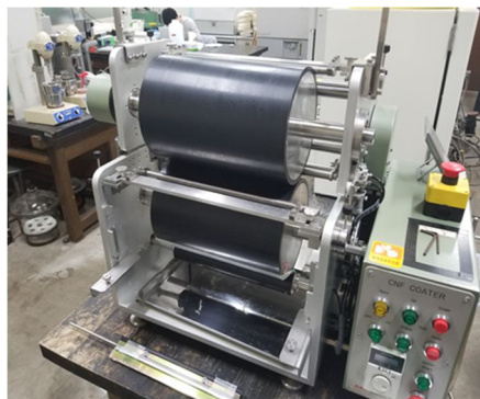
写真1 FCF塗工用小型塗工機
