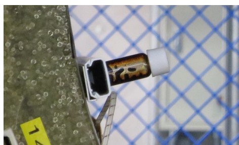
図3：磁場中においた磁性流体の変形
