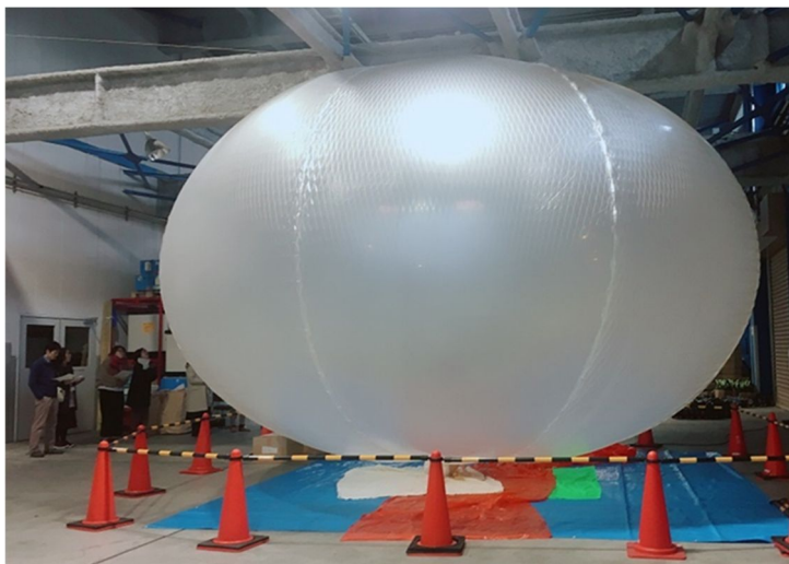
図 1: 2019 年 12 月に国立極地研究所で実施した体積 100 \text{ m}^3 の SP 気球の気密試験の様子。
