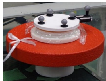
図 4．作成した小型ブイの外観
