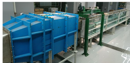
図1. 風波水槽の(左図)概略図、(右図)写真
