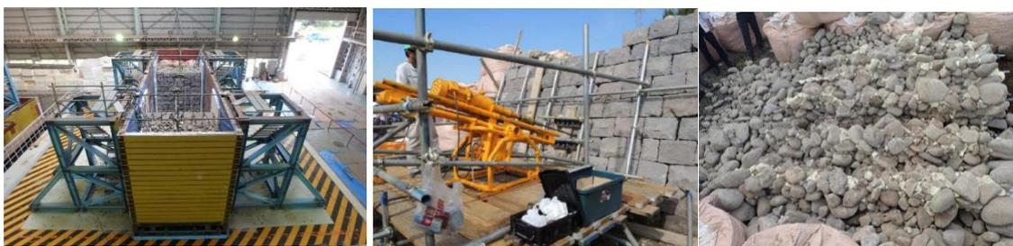
写真-3 大型振動台実験（防災科研）<sup>4)</sup> 写真-4 石垣の削孔実験 写真-5 石垣固結工法の実験
