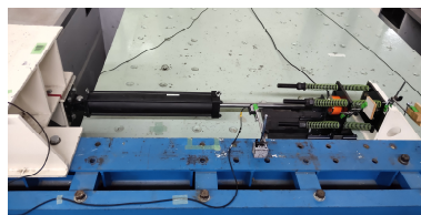
図3 Maxwell型ダンパー試験体を用いたリアルタイムハイブリッド実験
