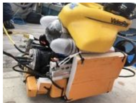
図5 超小型ROVに搭載された現場型 ATP 定量分析装置および各種化学セン
