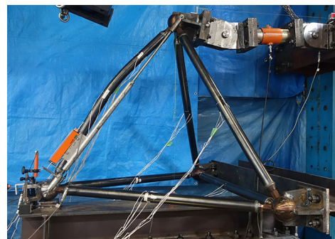
図 6 トラスユニット座屈実験
