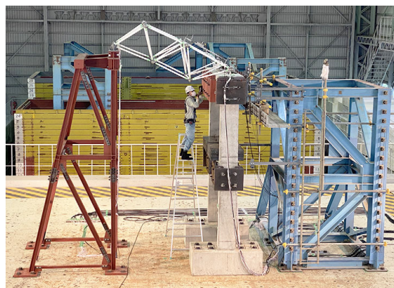
図 11 RC 支持架構による本振動台実験 (2020.7)
