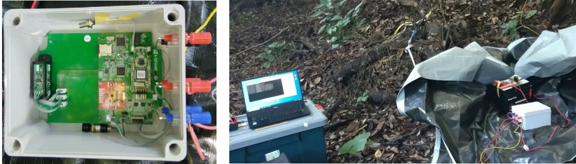
図 4 流体流動電磁法のプロトタイプ機の改良機の測定回路(左)とプロトタイプ機を用いたフィールド実験の様子(右)
