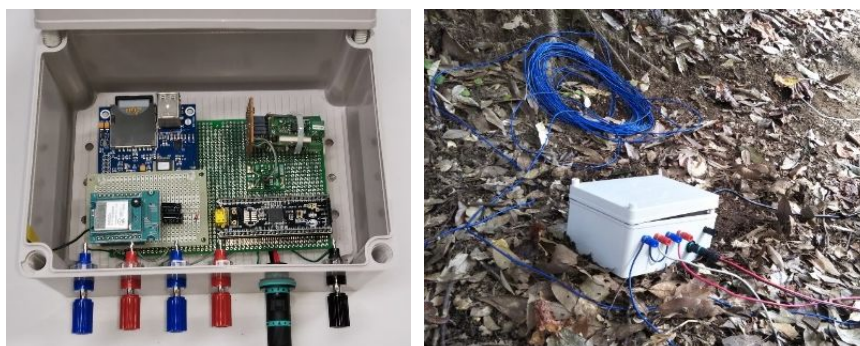
図 2 三軸磁場センサを内蔵した流体流動電磁法の測定装置の測定回路(左)とプロトタイプ機を用いたフィールド実験の様子(右)
