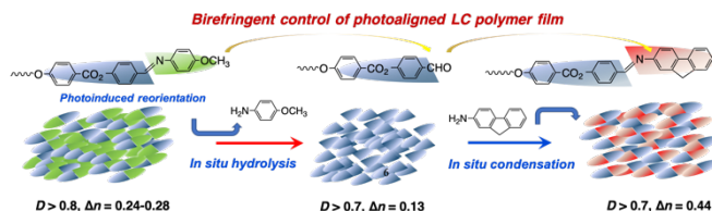
図6. 分子配向したのちに加水分解しフェニルアミン類との再結合による機能化
