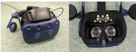
図2 脳波を測定する機器 8) VIVE PRO EYE および Looxid Link
