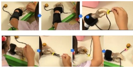
図7.おもちゃの糸通しの練習風景（筋電義手で糸を保持し、健側でビーズを入れる）
