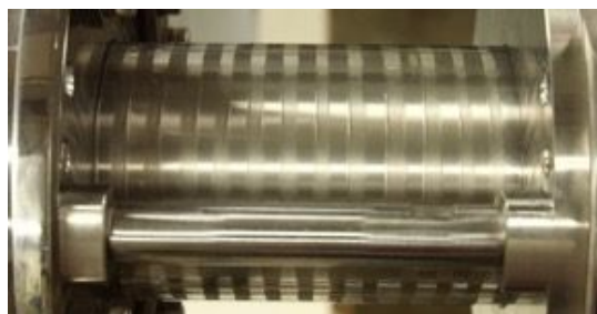
図4 理想的なテイラー渦流系の気液スラグ流
