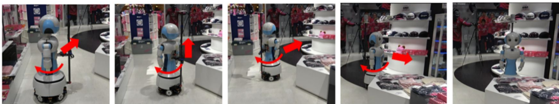
図 6: 提案手法を全方向移動型ロボットに実装し、店でナビゲーション実験を行った様子
