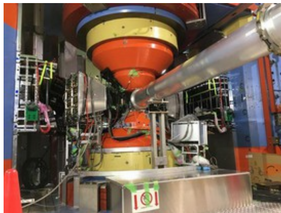
写真 1. スペクトロメータ磁石内部に設置された検出器。右上から中央にかけて走るのはビームパイプ。
