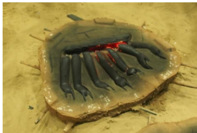
木造原型焼き抜き法の実験(型を開いた直後(部分的燃焼))
