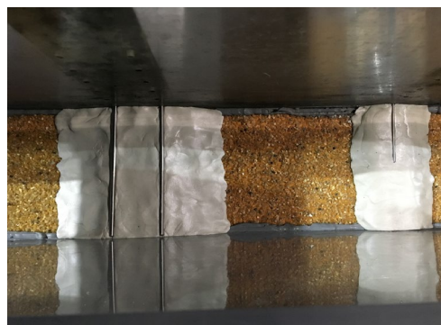
図-3 水路床に固定したセンサーの様子
