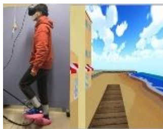
図5 砂浜を歩く感覚を提示できるジャミングシューズ
